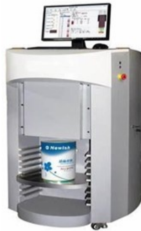
चित्र 4.6— अनुकूलित कम्प्यूटरीकृत रंग मिश्रण यंत्र
